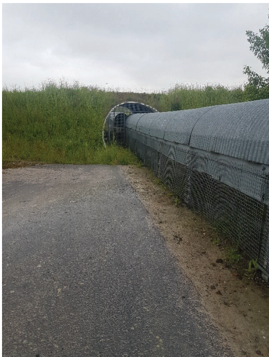
Abb. 14: Beispiel Bandanlage mit Schutzgittern
